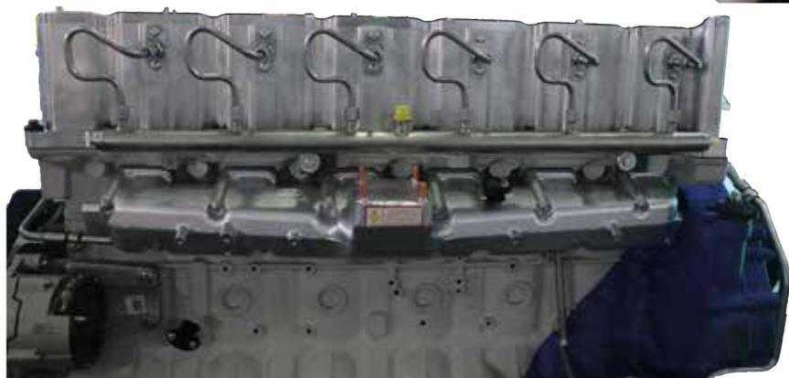
Avl ha presentato in occasione di Agritechnica il primo motore dimostrativo a idrogeno al Mondo con doppio sistema di alimentazione, diretta e port fuel. Antepresa che si affianca al recente lancio di un motore prototipale a idrogeno ad alte prestazioni specifico per il settore racing e forte di una potenza specifica di 205 cavalli/litro
